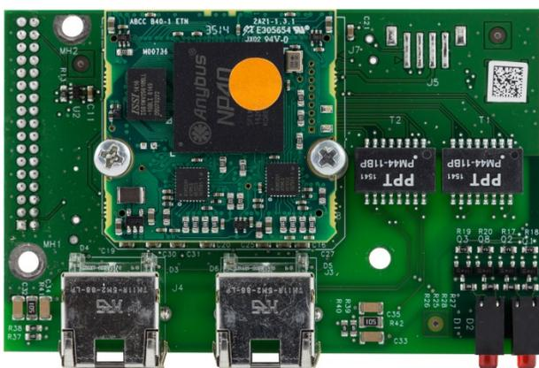
Figure 7-1 : Module PROFINET
