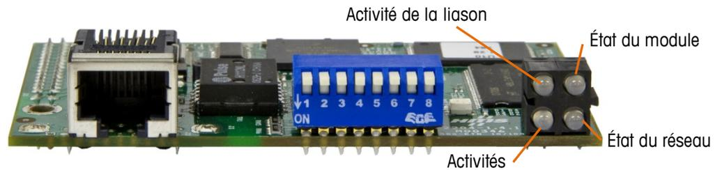
Figure 4-3 : DEL d'indication de l'état Ethernet/IP
