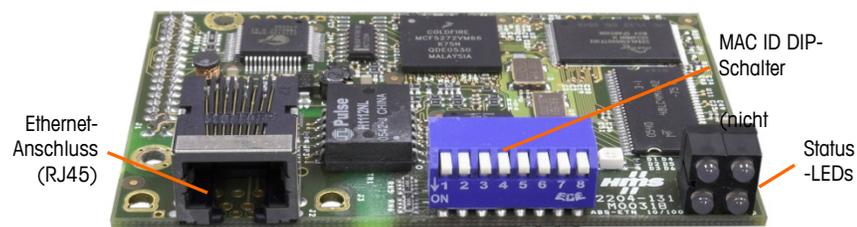
Abbildung 4-1: Ethernet/IP-Modulkomponenten
