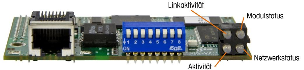
Abbildung 4-3: Ethernet/IP-Statusanzeigen-LEDs
