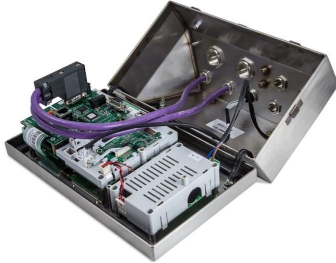
Abbildung 6-6: PROFIBUS-Optionsplatine im Terminalgehäuse für aggressive Umgebungen
