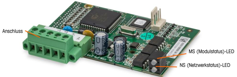
**Abbildung 3-1: Komponenten der DeviceNet-Optionsplatine**
