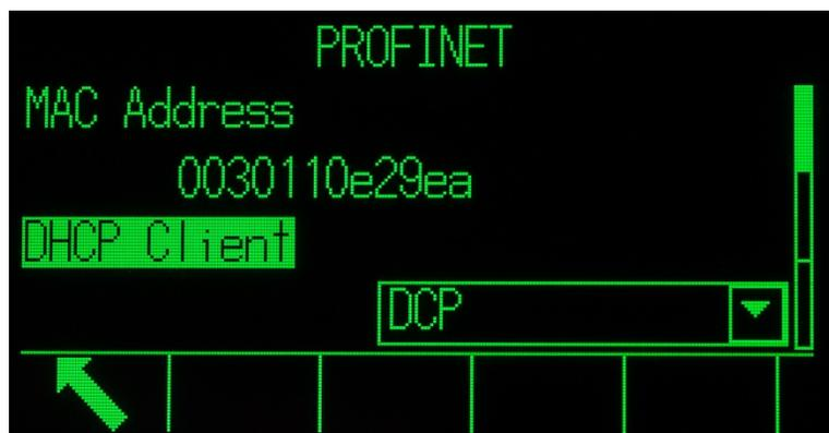
Abbildung 7-127-13: Anzeige der PROFINET MAC-Adresse des Terminals IND570
