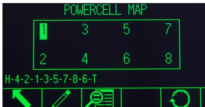
Figura 3-22: Mapa de Célula de Carga PDX Concluído
