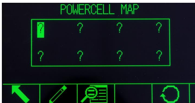
Figura 3-26: Mapa do POWERCELL desconfigurado
