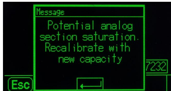
Abbildung 3-7: Warnung bei Sättigung des Analogabschnitts
