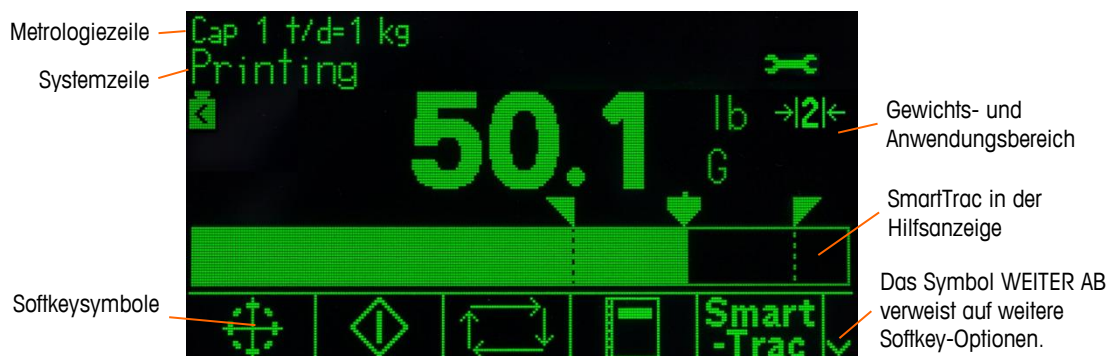
Abbildung 2-14: Standardausgangsbildschirm, Systemzeile mit Druckmeldung
