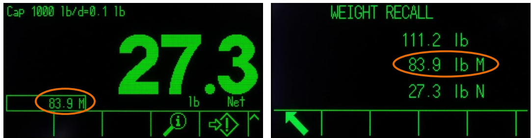
Abbildung 2-15: Taraanzeigen mit aktivierter Nettozeichenkorrektur
