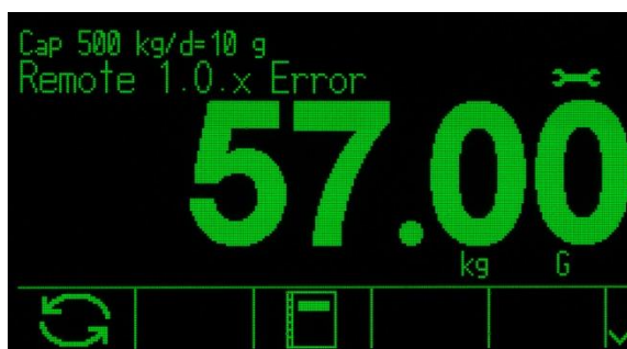
Abbildung 2-35: Anzeige des asynchronen Fehlers in der Systemzeile
