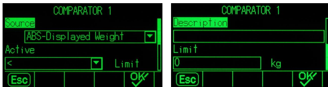
Abbildung 2-27: Konfigurationsbildschirme für den Komparator
