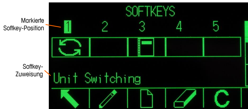
Abbildung 3-15: Setup-Bildschirm für die Softkeys
