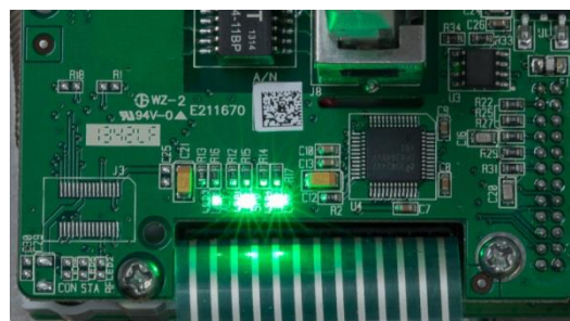
Abbildung 5-7: LEDs für Ethernet ECP/IP
