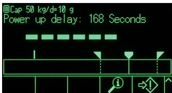
Abbildung 3-6: Anzeige der Verzögerung beim Einschalten in der Systemzeile
