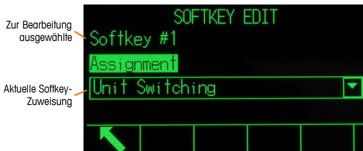
Abbildung 3-16: Der Bildschirm „Softkey bearbeiten“
