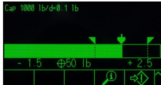
Abbildung 4-17: SmartTrac-Anzeigegrößen im Materialtransfermodus
