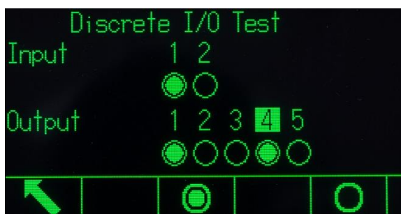
Abbildung 5-11: Bildschirm für den Test der diskreten I/O-Schnittstelle
