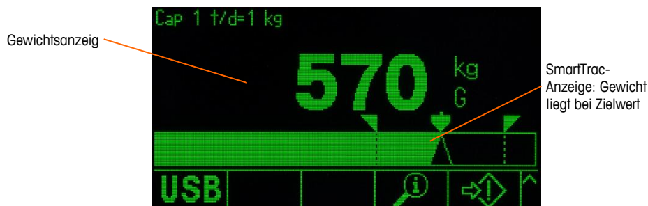
Abbildung 2-20: SmartTrac für Materialtransfer, klein
