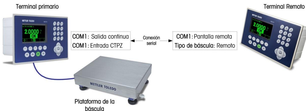
Figura 2-16: Función de pantalla remota a través de comunicación serial
