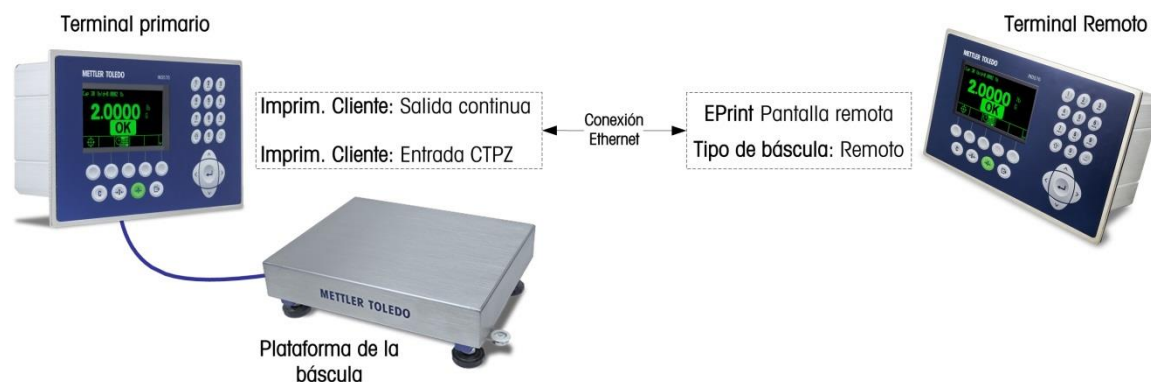
Figura 4-16: Ejemplo de configuración de terminal para función de pantalla remota vía Ethernet
