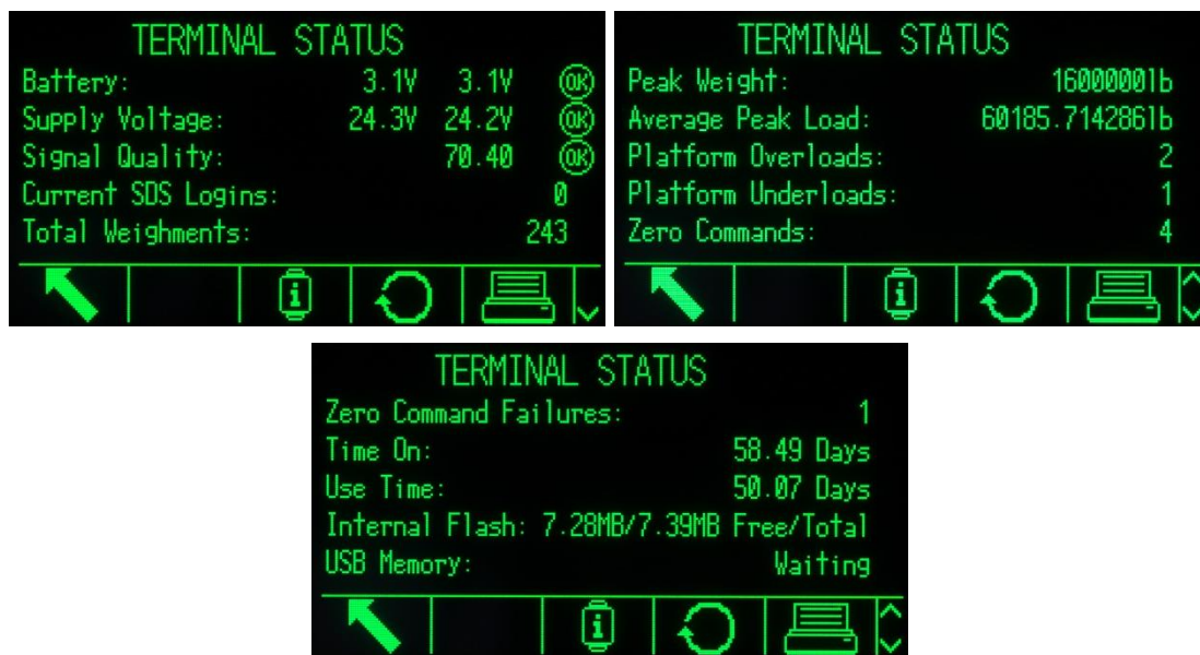
Figura 2-39: Pantallas del estado del terminal
