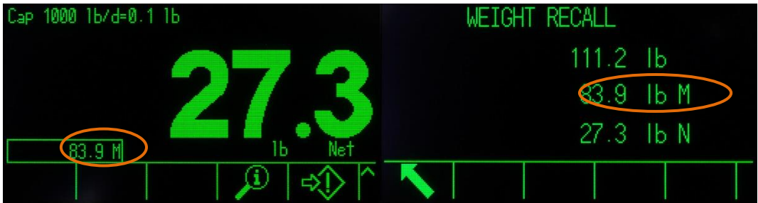
图 2-15: 在净重符号修正允许时的皮重显示
