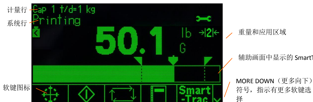
图 2-14: 默认主窗口，系统信息具有显示的打印报文
