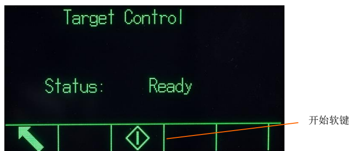
图 2-17: 目标值控制中“就绪”状态的示例
