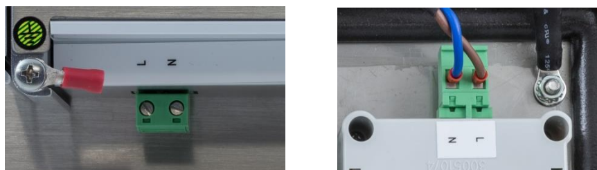
图 5-13: 交流电测试点一面板（左）和防尘（右）
