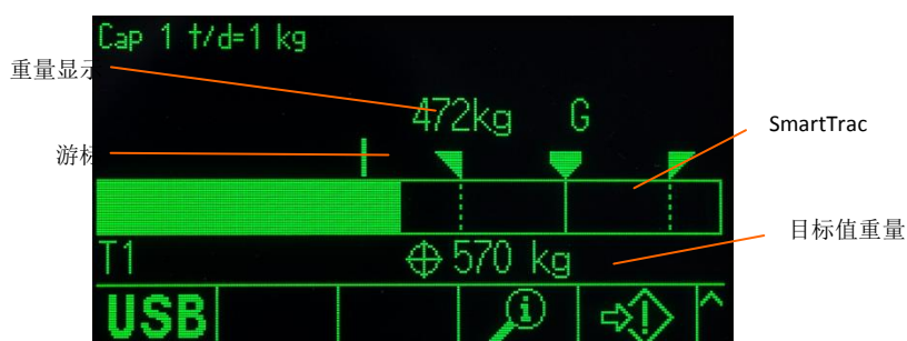
图 2-21: 物料传输 SmartTrac, 中号
