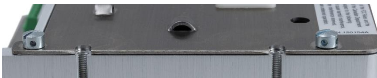
图 A-77: 安装了铅封螺丝
