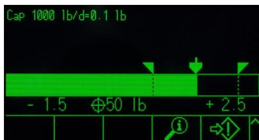
图 4-10: 物料传输模式中的 SmartTrac 显示规格
