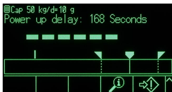
图 3-6：系统信息行显示开机延时
